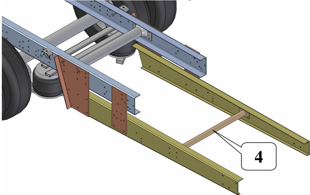
5. An den Querträger [5], schrauben Sie die zwei Verstärkungsplatten [6], den Kugelkopf [7] und das Steckdosenblech [8]. Hierfür werden die Sechskantschrauben M10x125, Unterlegscheiben und Sicherungsmuttern M10 verwendet (zwischen Kugelkopf und Steckdosenblech wird eine dicke Unterlegscheibe 10,5 [9] gelegt).
