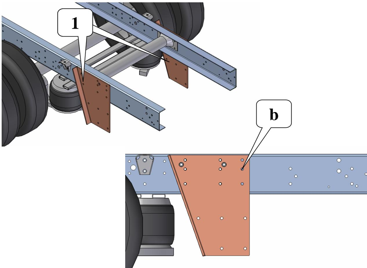
2. Schrauben Sie jetzt die hintere Seitenplatte [2], mit jeweils 2 Sechskantschrauben M12x40, Unterlegscheiben und Sicherungsmuttern M12 und 2 Sechskantschrauben M16x40, Unterlegscheiben und Sicherungsmuttern M16 an das Chassis.
