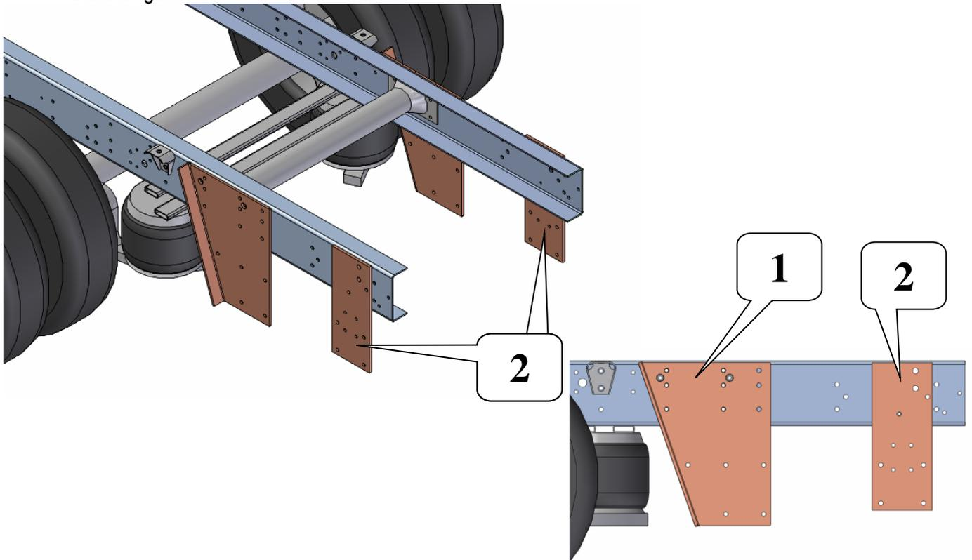
3. An die beiden Seitenplatten [1,2] werden die Längsträger [3] angeschraubt, hierfür verwenden Sie die Sechskantschrauben M12x40, Unterlegscheiben und Sicherungsmuttern M12.
