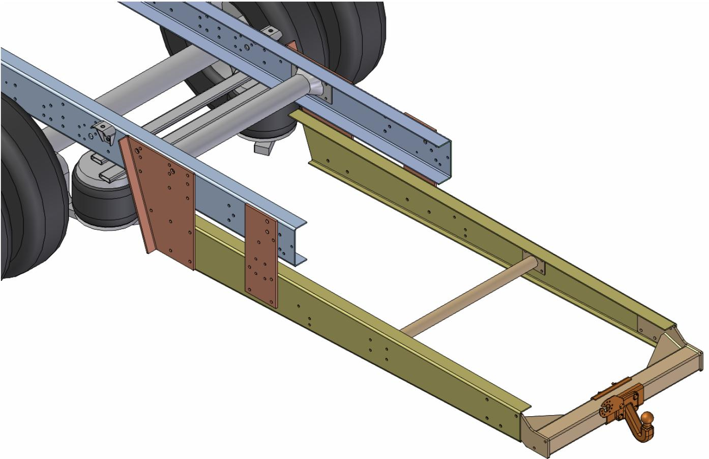
7. Zuletzt die komplette AHK ausrichten und alle Verschraubungen mit den vorgeschriebenen Drehmomenten anziehen.
