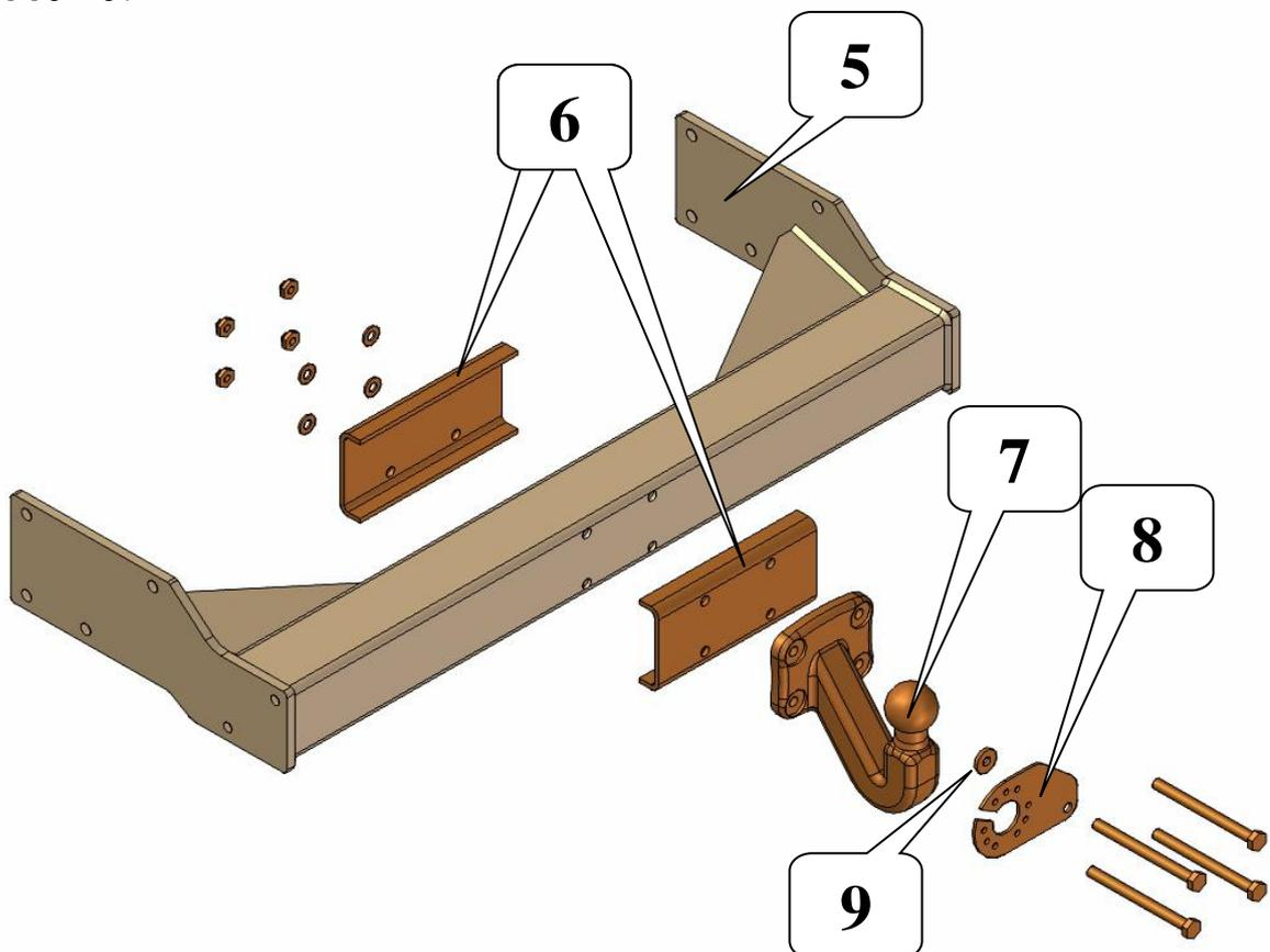
6. Schrauben Sie den vormontierten Querträger zwischen die beiden Längsträger [3], hierfür verwenden Sie die Sechskantschrauben M12x40, Unterlegscheiben und Sicherungsmuttern M12.
