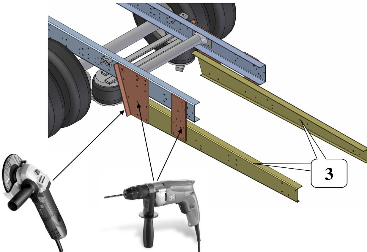
4. Zwischen die beiden Längsträger [3], schrauben Sie die Querstrebe [4], hierfür verwenden Sie die Sechskantschrauben M10x40, Unterlegscheiben und Sicherungsmuttern M10.
