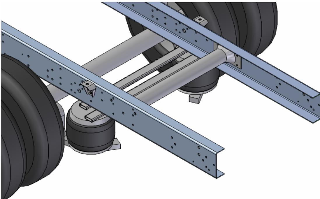
1. Halten Sie die vordere Seitenplatte [1] an das Chassis. Übertragen und bohren Sie die drei Bohrungen (b), hierfür verwenden Sie einen Spiralbohrer  $d=13\text{mm}$  (die Bohrungen sind zu entgraten und gegen Korrosion zu schützen). Schrauben Sie die Seitenplatten mit den Sechskantschrauben M12x40-10.9, Unterlegscheiben und Sicherungsmuttern M12 an das Chassis.
